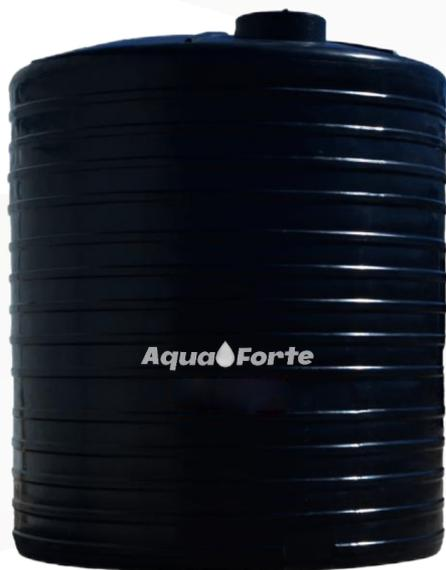
El Tanque domestico con capacidad de 20,000 litros esta fabricado con copolímero de polietileno media densidad (unicapa) 100% virgen grado hexeno en color negro con estabilizador U.V. 8. el cual impide el paso de la luz solar al interior del tinaco evitando la formación de bacterias.
